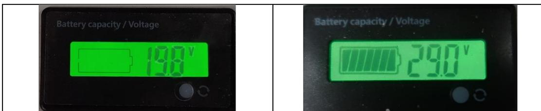
En appuyant une deuxième fois sur le bouton, on peut voir le niveau de charge de la PEMP grâce à un barre graphe qui va jusqu'à 8 barres.
