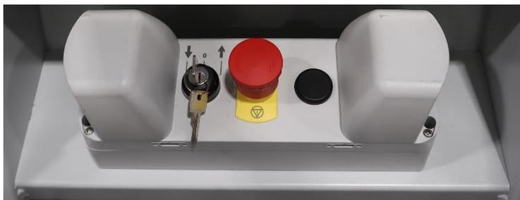
Afin d'éviter tout coincement, écrasement ou autre lors du cycle d'utilisation de la nacelle, la PEMP ERGOLIFT® est équipée d'une commande bimanuelle.
