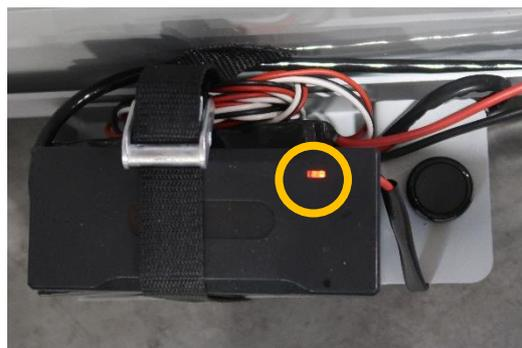
Si le voyant est déjà vert et que ni l'afficheur de batterie, ni l'interrupteur lumineux ne fonctionne, veuillez svp prendre contact avec votre revendeur ERGOLIFT. Remettre ensuite le capot et les vis
