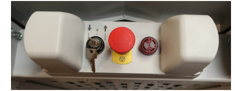
Poste de commandes de la plateforme
